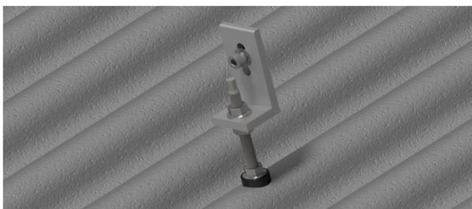
**5.** Realize a montagem do suporte conforme a imagem. Utilize chave canhão ou sextavada apropriada, torque indicado = 18-29 N\*m.
